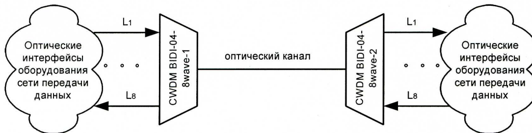
Схема присоединения оборудования к сети связи общего пользования
